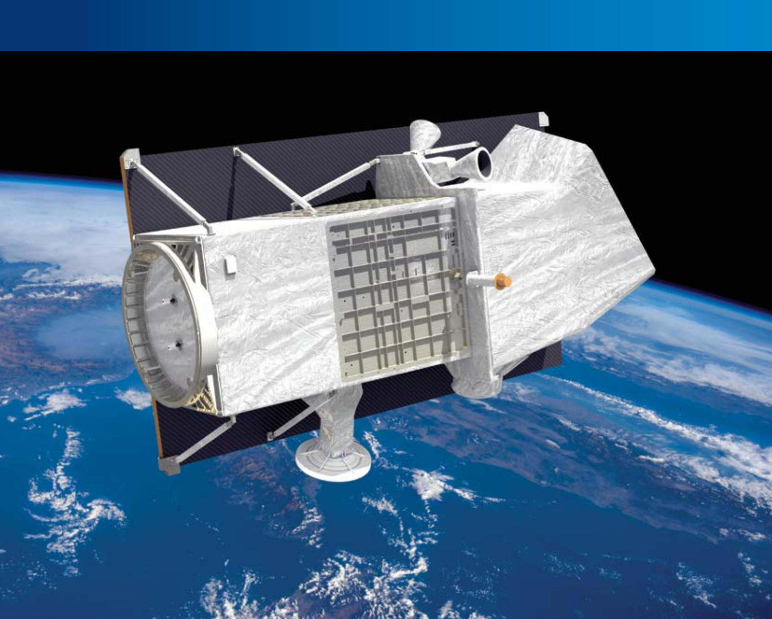
PRISMA - PR ecursore IperS pettrale della M issione A pplicativa dell'ASI è un satellite per l'Osservazione della Terra, dotato di un potente strumento iperspettrale. ASI Hyperspectral Precursor of the Application Mission is a satellite for Earth Observation equipped with a powerful hyperspectral instrument. Credits: ASI
